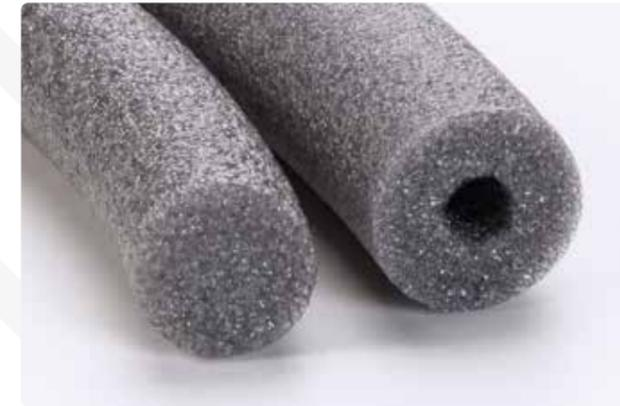
**Die PE Rundprofile** werden aus geschlossenzelligem Polyethylenschaum speziell für die Hinterfüllung von kalt verarbeitbarer Fugenmasse hergestellt. Sie haben die Aufgabe die Haftung der Dichtmasse am Fugengrund zu vermeiden und stellen darüber hinaus die erforderliche Vergusstiefe sicher.
